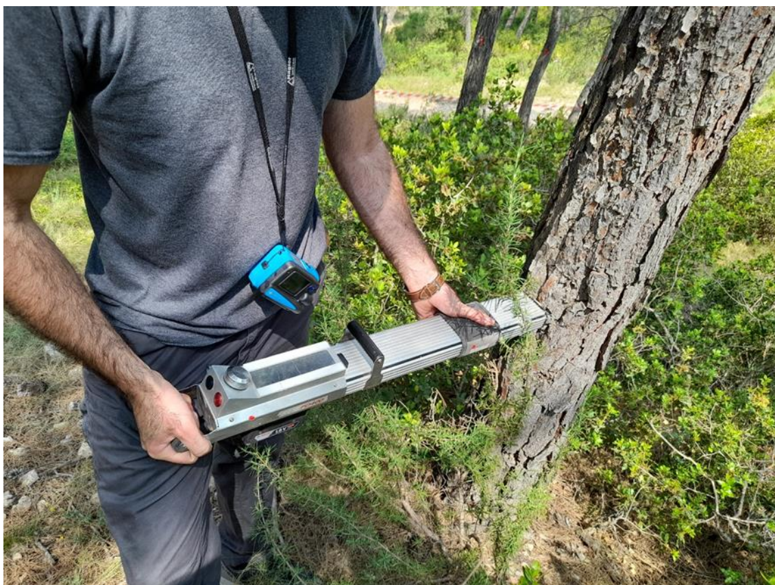
Ensayo equipo de resistografía sobre arbolado
